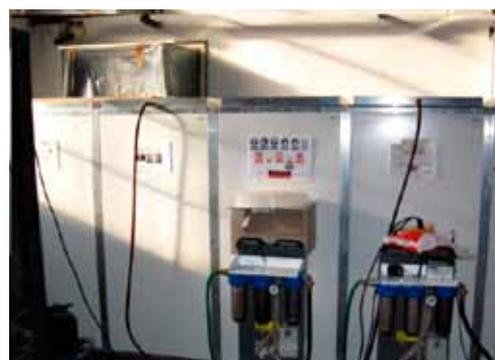
Figura 4. Unidad de descontaminación del personal
