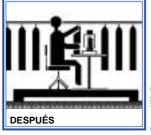
En esta fábrica textil, al elevarse el puesto de trabajo, el operador de la máquina de coser ya no tiene que estirarse de forma tan incómoda
