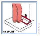
Un nuevo diseño del pedal reduce la fuerza que necesita el operario para poder utilizarlo.
